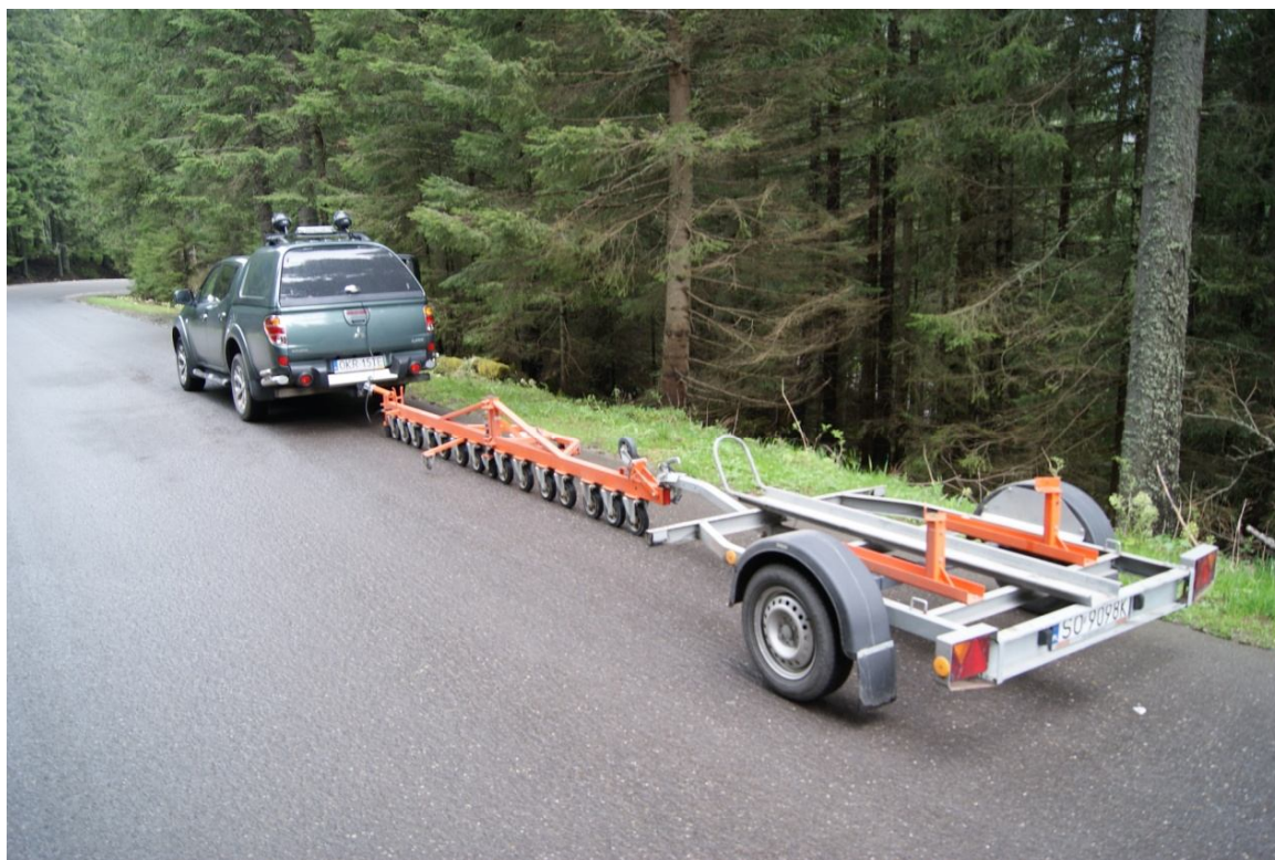
Rys. 2. Planograf firmy Omega użyty do pomiaru równości podłużnej nawierzchni na trasie Włosienica-Palenica Białczańska –Łysa Polana ( fot. J.Mierczyński).
