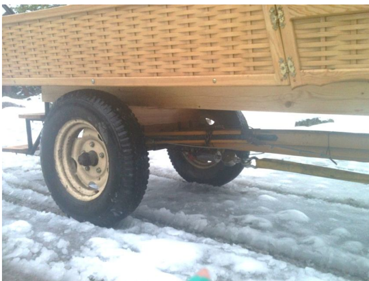
Rys . 4. Sposób zamocowania czujnika- do tylnej osi wozu- linką holowniczą.
