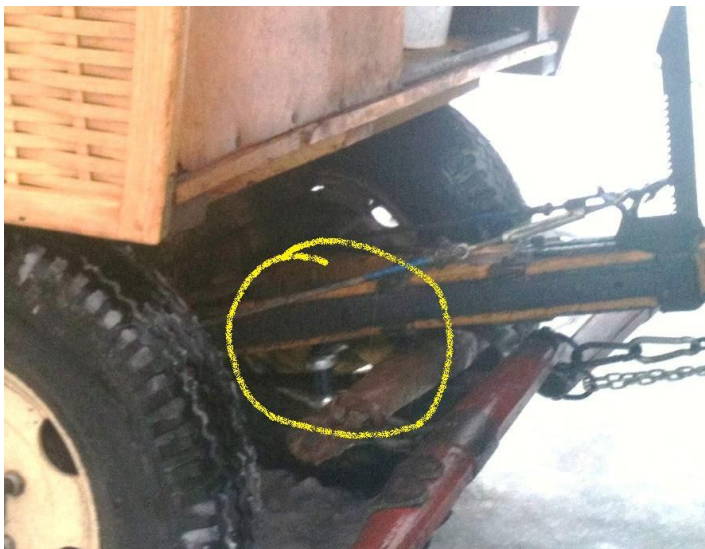
Rys. 6. Podwieszenie liny holowniczej do wozu ( element mocujący w kolorze srebrnym) i orczycy.
